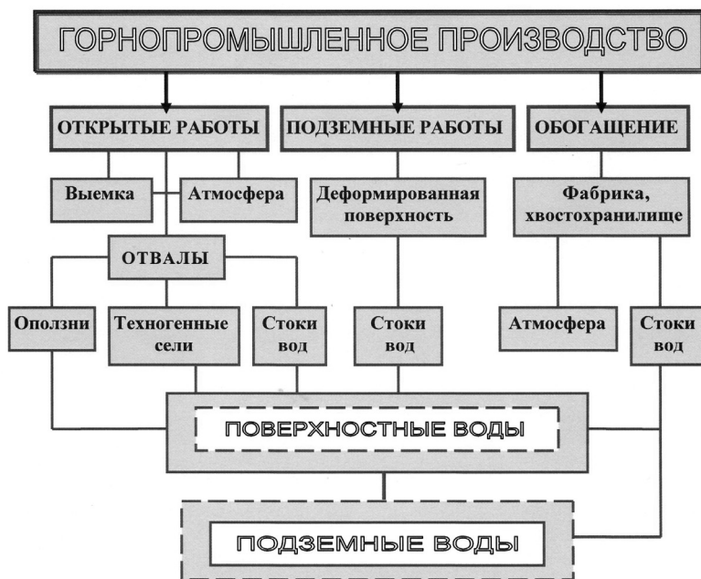
Рис. 1. Схема структуры работы горнопромышленного предприятия и его влияния на экологию района ведения работ (поверхностные и подземные воды)
