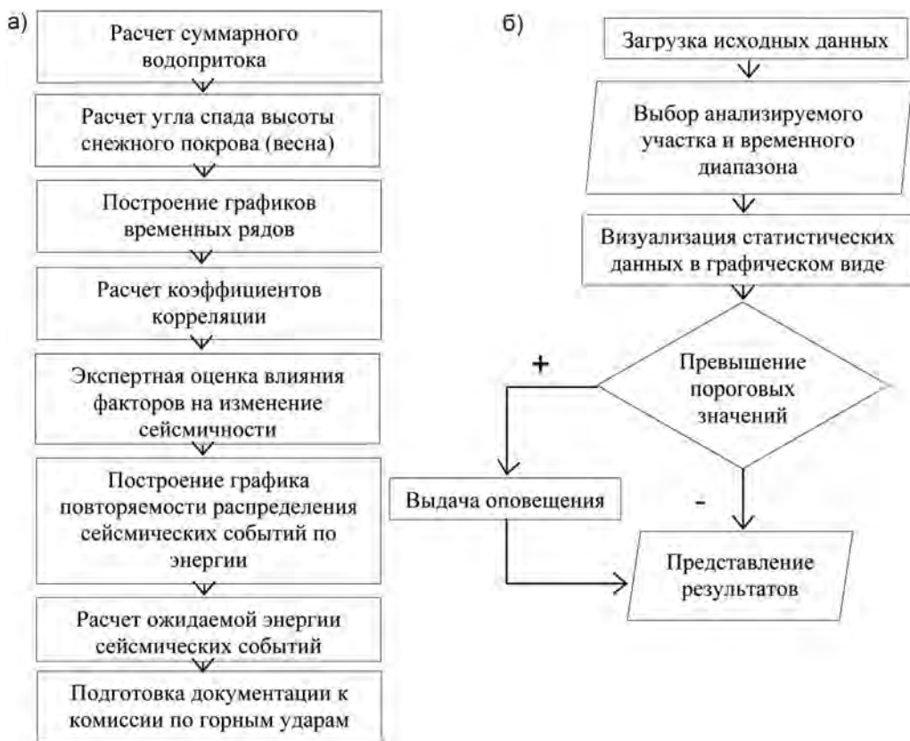
Рис. 2. Общая схема комплексной оценки данных метео- и гидрогеологического мониторинга для выявления периодов сейсмической активности на рудниках АО «Апатит» (а); блок-схема работы программной системы «SSAIS» (б)
