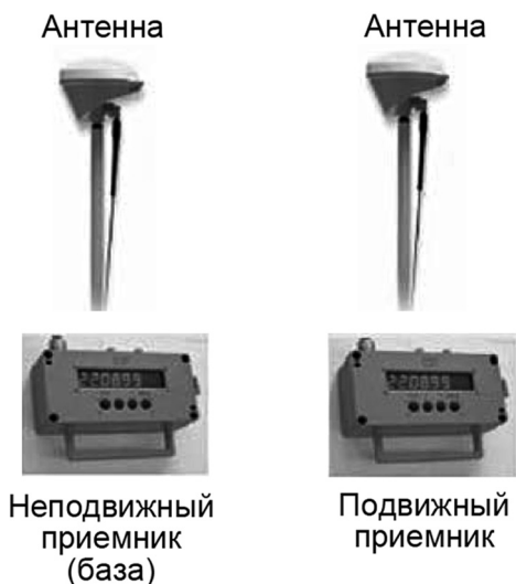
Рис. 4. Система оперативного позиционирования движущихся объектов
