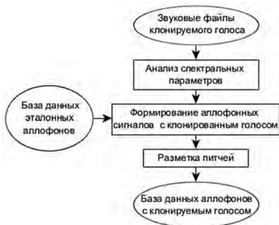
Рис. 7. Схема автоматизации создания базы данных аллофонов с клонированным голосом
