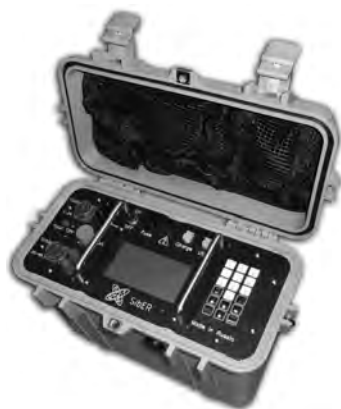
Рис. 3. Программно-аппаратурный комплекс Скала-48 (Siber), реализующий метод электротомографии (ИНГГ СО РАН, КБ Электрометрии, 2014 г.)
