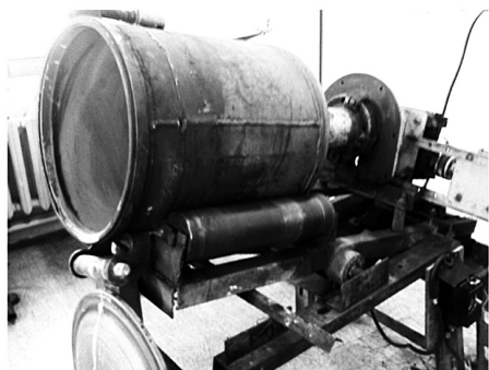
Рис. 1. Схема и общий вид лабораторной модели промывочного барабана
