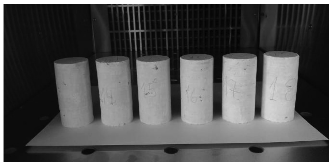
Рис. 1. Образцы мела в камере тепла и холода КТХ
