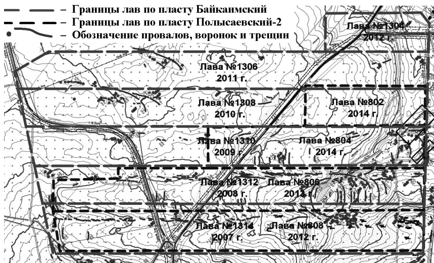
Рис. 2. Систематизация данных о провалах и разрывных нарушениях
