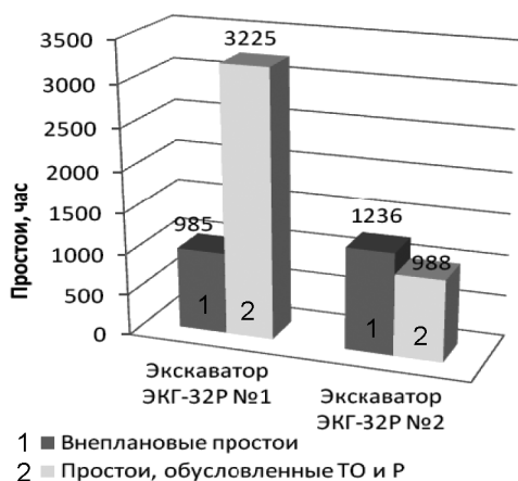
Рис. 5. Простои экскаваторов ЭКГ-32 Р № 1 и № 2 с момент ввода в эксплуатацию по настоящее время
