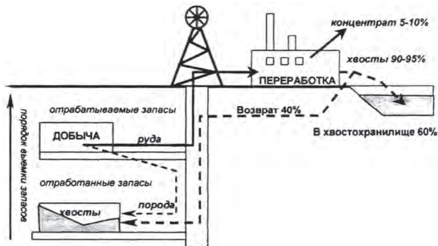
Рис. 5. Схема потоков горной массы и отходов при восходящем порядке горных работ с возвратом отходов в качестве закладки выработанного пространства
