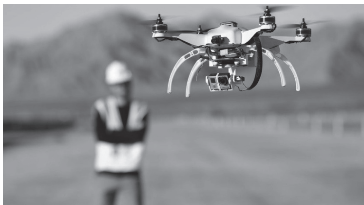
Рис. 8. Дрон, снабженный фото- и видеоаппаратурой взлетает над строительной площадкой Fig. 8. Drone equipped with photo and video equipment flies over the construction site
