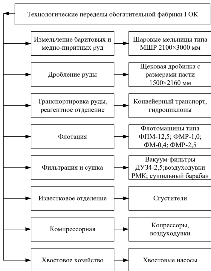
Рис. 1. Технологическая схема обогатительной фабрики Fig. 1. The technological scheme of the concentrating factory
