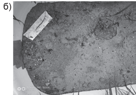
Рис. 5. Фрагмент экспериментального модуля ТГ – ИГБ (почва + шлак, шлак): почва+шлак (а); шлак (б) Fig. 5. Fragment of experimental module IS-AGCB (soil+slag, slag): a- soil+slag; b-slag
