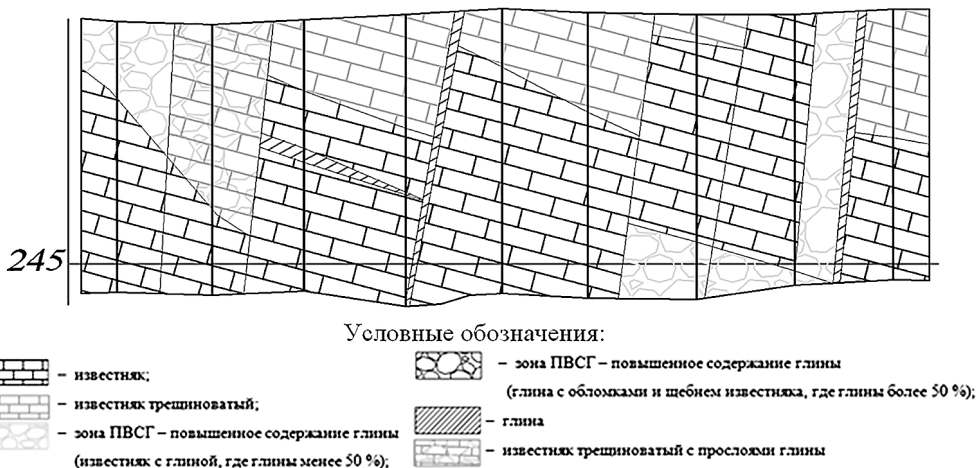
Рис. 2. Характерное геологическое строение взрывного блока в карьере Чаньвинского месторождения
