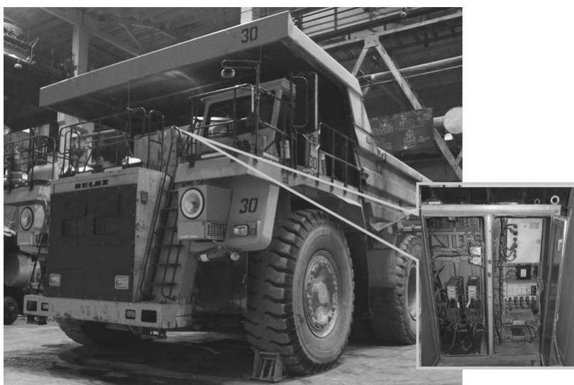
Рис. 2. Установка регистратора на карьерном автосамосвале для мониторинговых замеров Fig. 2. Installation of a recorder on a quarry dump truck for monitoring measurements
