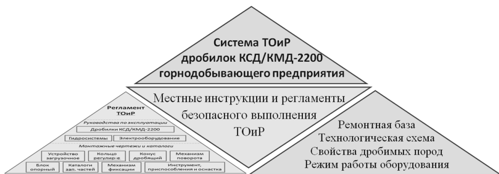
Рис. 1. Роль и место регламентов ТОиР в пирамиде элементов системы технического обслуживания и ремонта предприятия (на примере конусных дробилок КСД/КМД-2200)
