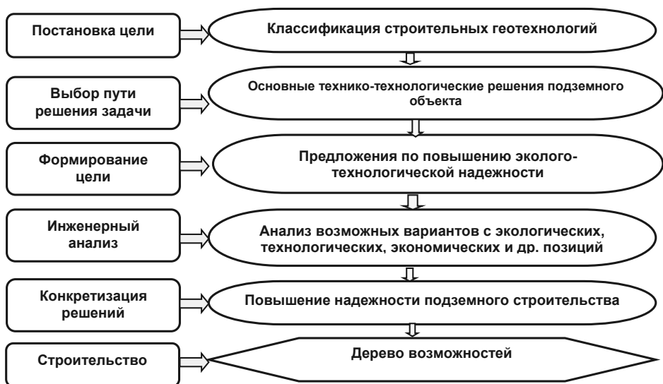
Рис. 1. Блок-схема мероприятий по повышению надежности освоения подземного пространства
