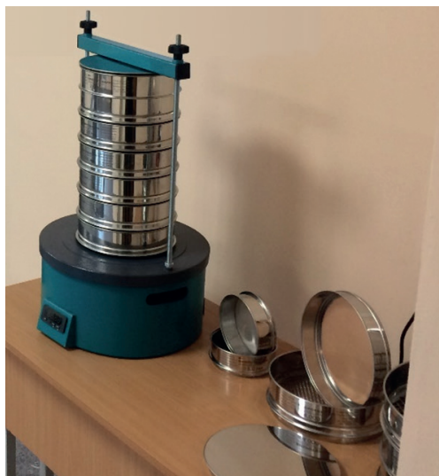
Рис. 3. Анализатор А20 на базе вибропривода ВП 30Т производства ООО «Вибротехник» (г. Санкт-Петербург)
