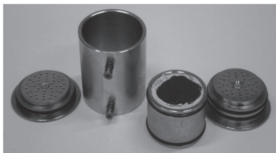
Рис. 15. Фотография угольного образца, вклеенного в металлический модуль для проведения испытаний Fig. 15. Picture of coal sample embedded in steel module for testing
