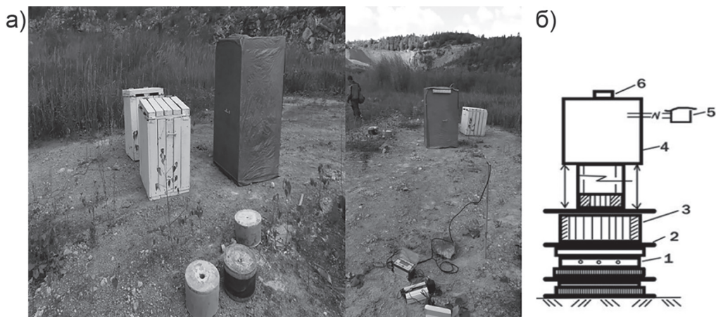
Рис. 2. Проведение работ на полигоне при одновременной оценке дробящего действия взрыва, показателей ударной воздушной волны и сейсмического эффекта (а); схема испытательного стенда (б): 1 – камера; 2 – ребра жесткости; 3 – зона разгрузки; 4 – емкость для сбора продуктов детонации; 5 – устройство для сбора проб газообразных продуктов детонации; 6 – клапан для сброса избыточного давления
