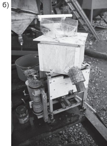
Рис. 4. Центробежно-вибрационный концентратор (ЦВК) разработки ИГДС СО РАН: принципиальная схема концентратора (а); общий вид концентратора (б); 1 – рабочий орган, 2 – улавливающие рифли, 3 – центральный вал, 4 – приводной вал, 5 – несущие подшипники, 6 – несущий корпус, 7 – клиноременная передача, 8 – электродвигатель, 9 – сердечник вибратора, 10 – электрические катушки вибратора, 11 – патрубок исходного питания, 12 – устройство для разгрузки продуктов разделения
