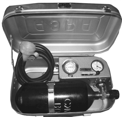
Рис. 1. Автоматический эжекторный рудничный аспиратор АЭРА Fig. 1. Automated mine exhaust ejector AERA
