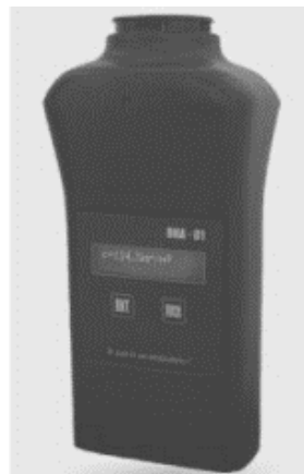
Рис. 8. Прибор контроля запыленности ПКА-01 Fig. 8. Dust content controller PKA-01
