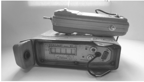
Рис. 4. Пылемер ИКАР ФБ-01 (рис. авторов)
