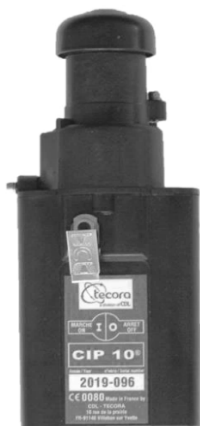
Рис. 3. Аспиратор CIP 10 Fig. 3. Exhauster CIP 10
