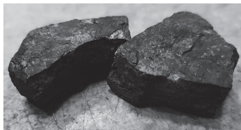
Рис. 4. Образцы исследуемого каменного угля с сульфидными включениями Fig. 4. Test coal samples with sulfide nodules
