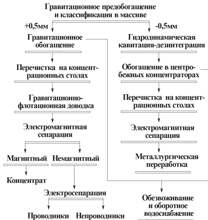
Рис. 2. Принципиальная схема предобогащения минерального сырья
