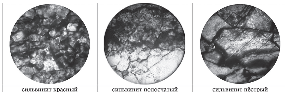
Рис. 1. Микроструктура образцов под микроскопом (увеличение \times 25 , без анализатора) Fig. 1. Microstructure of sample (magnification \times 25 , without analyzer)
