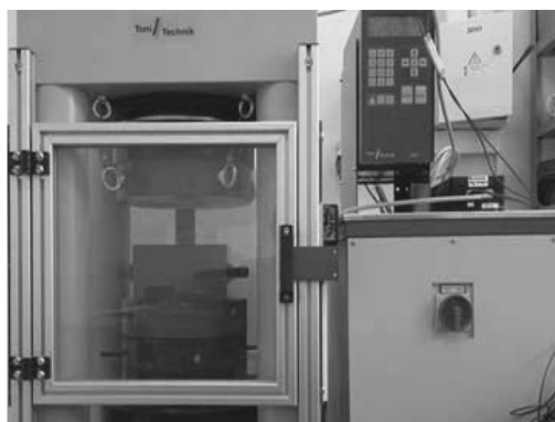
Рис. 1. Материалы и оборудование: а — образцы испытываемых горных пород; б — размещение образца между плитами испытательной машины ToniPACT II
