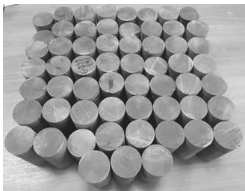
Рис. 1. Материалы и оборудование: а — образцы испытываемых горных пород; б — размещение образца между плитами испытательной машины ToniPACT II
