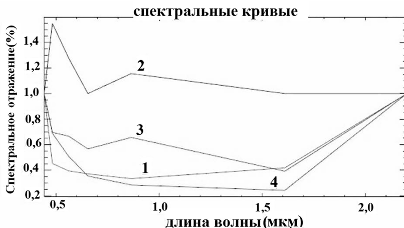
Рис. 3. Спектральные характеристики загрязнения воды на участке в Сунтарском районе: 1 – спектр до прорыва дамбы на 19-08-2017, 2 – спектр после прорыва дамбы на 28-08-2018, 3 – спектр после прорыва дамбы через месяц на 19-09-2018; в качестве эталона под номером 4 выделена спектральная кривая оз. Байкал [15]
