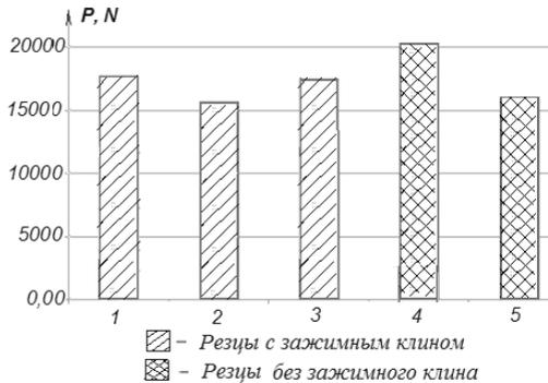
*Рис. 5. Диаграмма прочности различных способов крепления резцов: 1 – сварка хвостовика резцов без упора; 2 – сварка хвостовика с припаенным резцом в пазу коронки; 3 – пайка хвостовика резцом с упором; 4 – пайка резцов в пазу клиньями-припоями газовым аппаратом «Лига 1»; 5 – пайка резцов в пазу клиньями-припоями в солевом расплаве*
