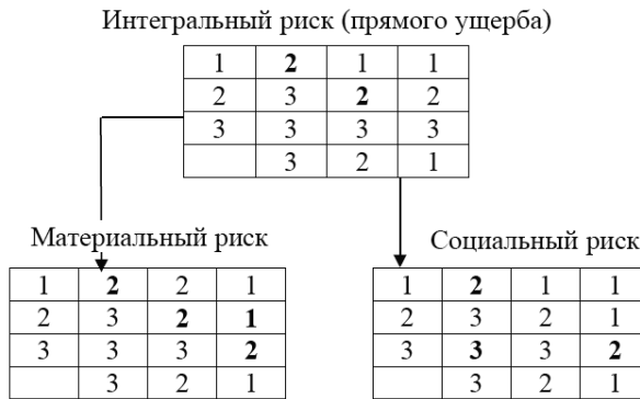
Рис. 2. Логические матрицы свертки Fig. 2. Logical convolution matrices
