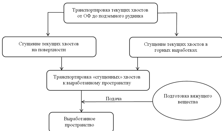
Рис. 3. Блок-схема последовательности действий закладки на основе «сгущенных» хвостов Fig. 3. Flowchart of the sequence of actions of the bookmark based on "thickened" tails
