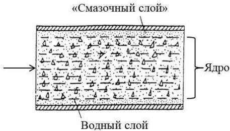
Рис. 2. Продвижение «сгущенных» хвостов в трубопроводе Fig. 2. Promotion of «thickened» tailings in the pipeline
