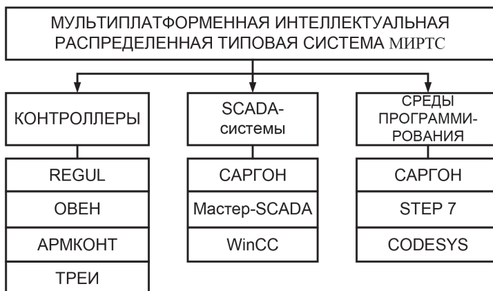
Рис. 1. Структура мультиплатформенной системы МИРТС
