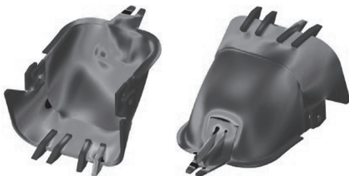
Рис. 2. Отображение поля напряжений по Мизесу на ковше экскаватора (черным обозначены значения выше 355 МПа) [19]
