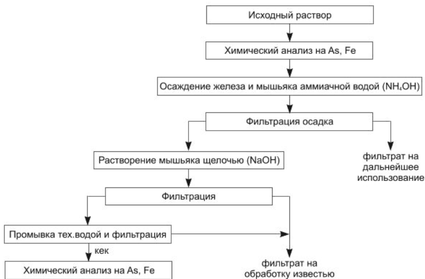
Рис. 4. Предлагаемая технологическая схема Fig. 4. Proposed flow diagram
