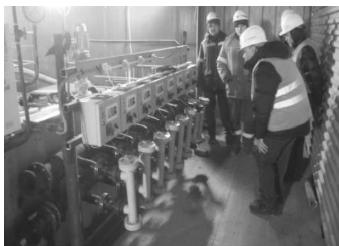
Рис. 2. Реакторы для проведения испытаний электрофотохимического кучного выщелачивания Fig. 2. Reactors for conducting electrophotochemical heap leaching tests
