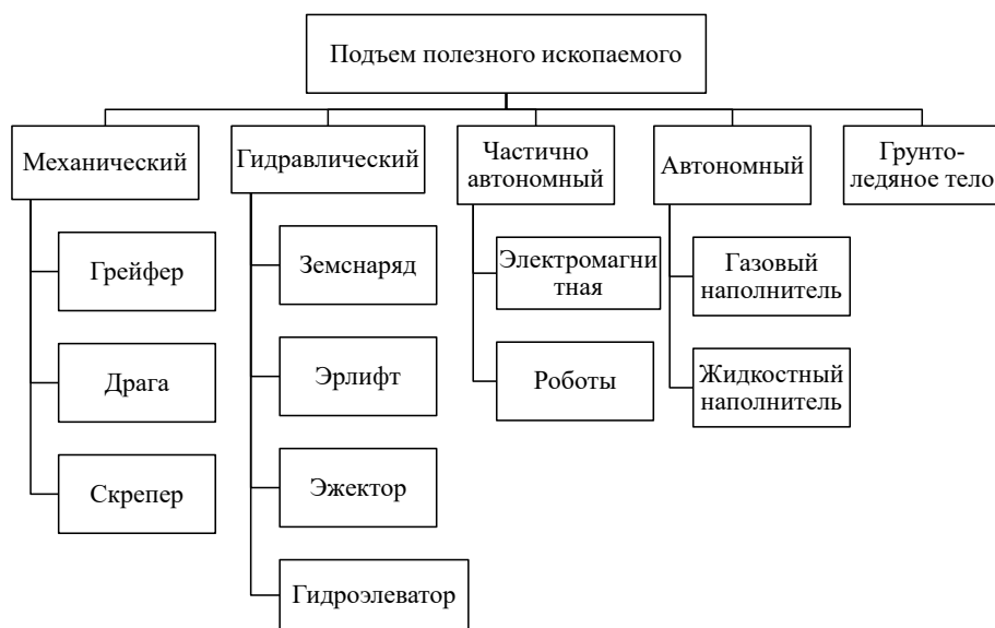
Рис. 1 Систематизация средств подводной добычи по принципу подъема полезного ископаемого
