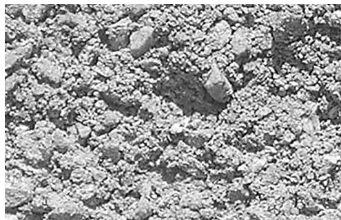
Рис. 1. Распределение окомкованного материала внутри дробленной руды после проведения процесса скоростного активированного КВ золота
