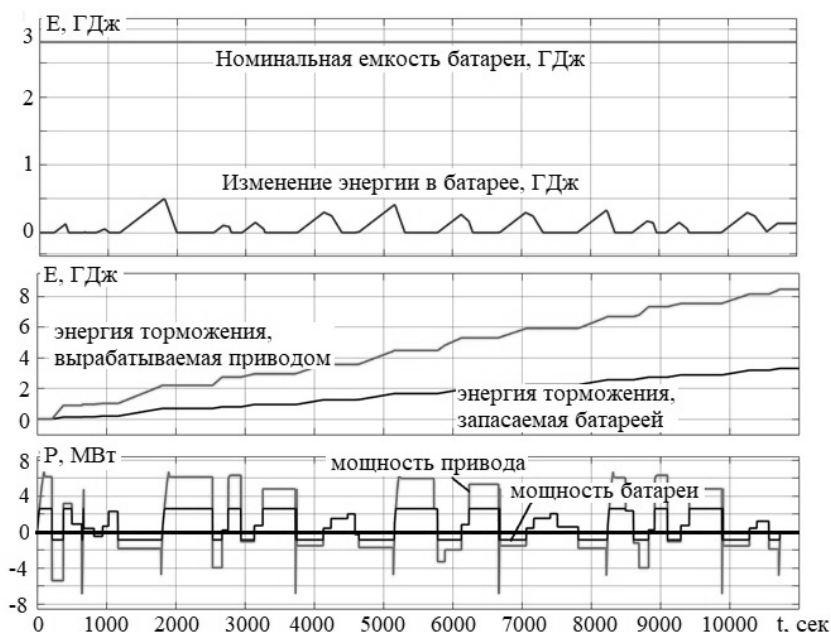
Рис. 3. Объем энергии в батарее и динамика изменения мощности Fig. 3. Battery energy and power
