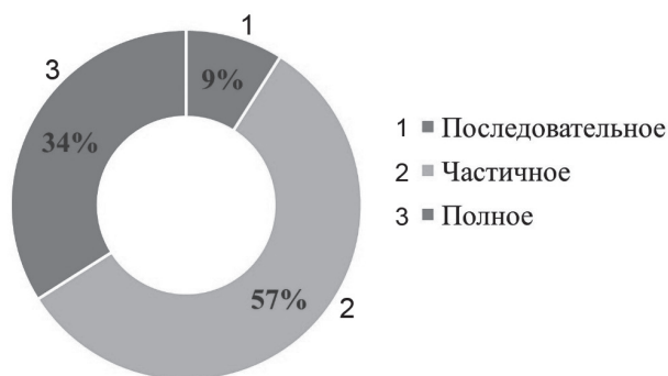
Рис. 1. Распределение схем проветривания по классам (степени обособленности разбавления метана по источникам его поступления)
