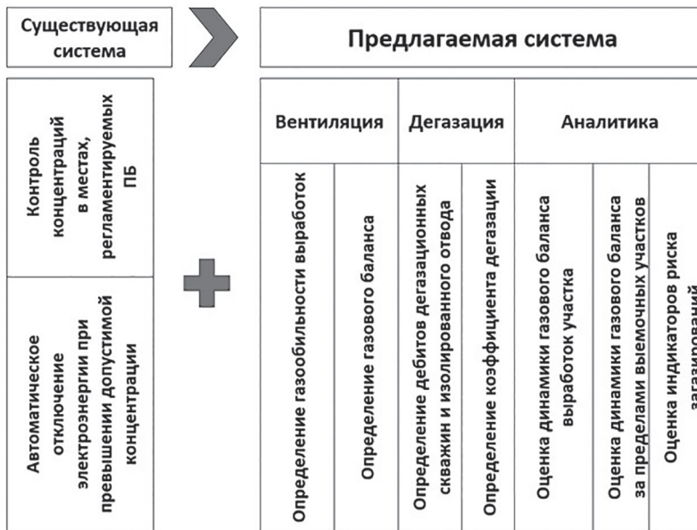
Рис. 3. Предлагаемые изменения функциональной структуры системы мониторинга метана в угольной шахте
