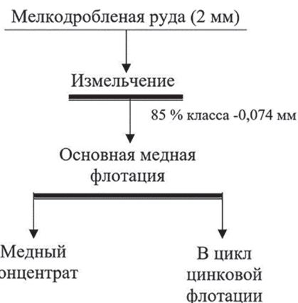
Рис. 2. Принципиальная схема флотации проб пиритных медно-цинковых руд Учалинского и Узельгинского месторождений
