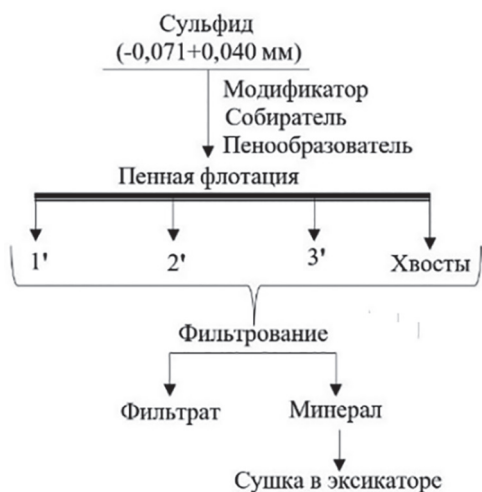
Рис. 1. Методика проведения кинетики пенной флотации мономинералов
