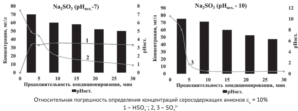
Рис. 5. Ионный состав раствора сульфита натрия в зависимости от продолжительности кондиционирования при \text{pH} 7 и 10
