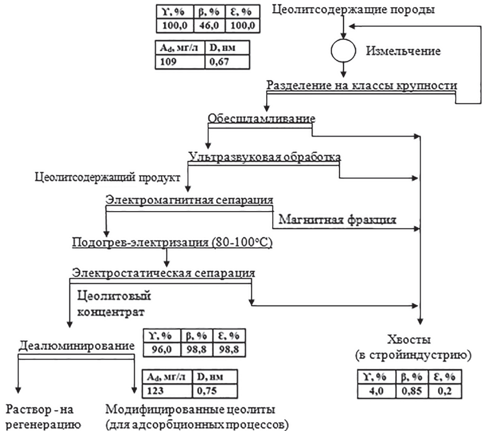
Рис. 1. Принципиальная схема обогащения и химического модифицирования ЦСП
