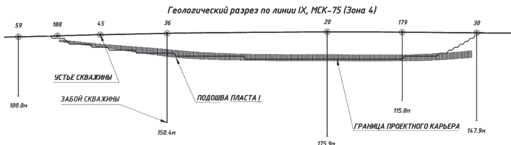
Рис. 5. Блочная модель пласта I Кутинского бурогоугольного месторождения
