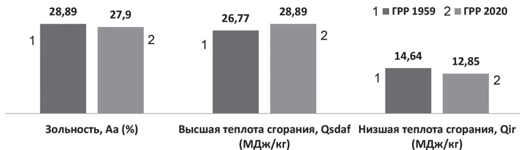
Рис. 6. Сравнительный анализ качественных показателей углей по блочной модели на основе данных опробования 1959 г. и данных эксплуатационной разведки 2020 г.
