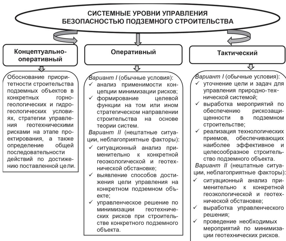
Рис. 1. Системные уровни управления безопасностью в подземном строительстве
