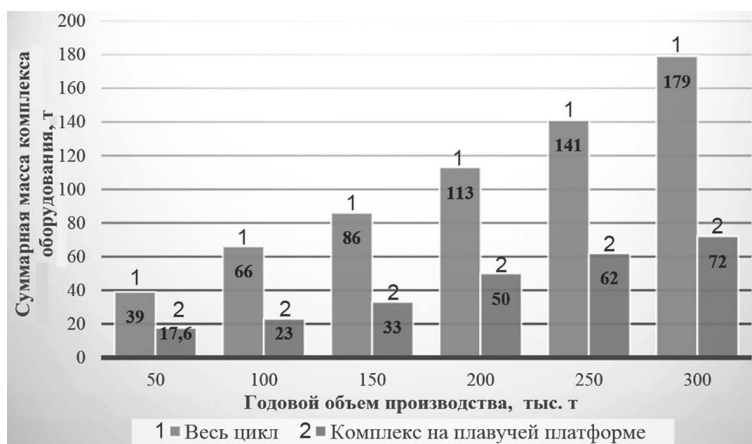
Рис. 7. Суммарные показатели массы комплекса оборудования при полном цикле «добыча-переработка» и при цикле «добыча-первичная переработка», расположенном на плавучей платформе
