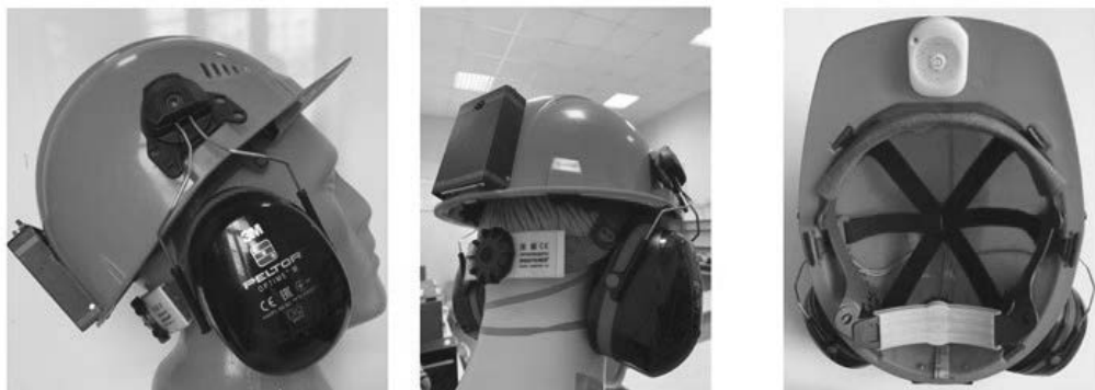
Рис. 2. Изготовленный прототип СИЗОС с функциями мониторинга и сигнализации (составлено авторами)
