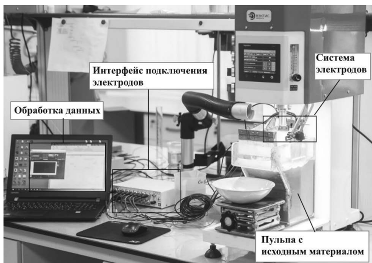
Рис. 2. Лабораторная установка контроля электрохимических параметров в флотомашине Fig. 2. Laboratory installation for monitoring electrochemical parameters in a flotation machine
