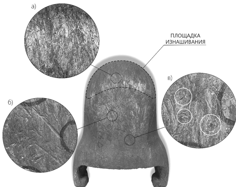
Рис. 2. Характерные виды дефектов на нижней поверхности коронки после работы по граниту
