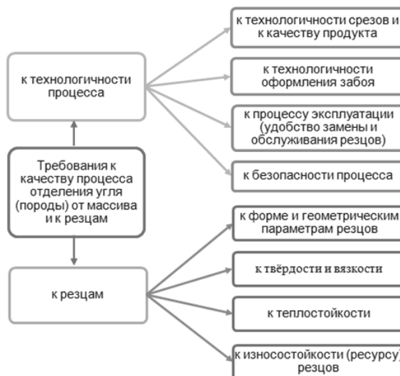
Рис. 3. Структура требований к качеству процесса отделения угля от массива и к резам выемочных машин (получен авторами)
