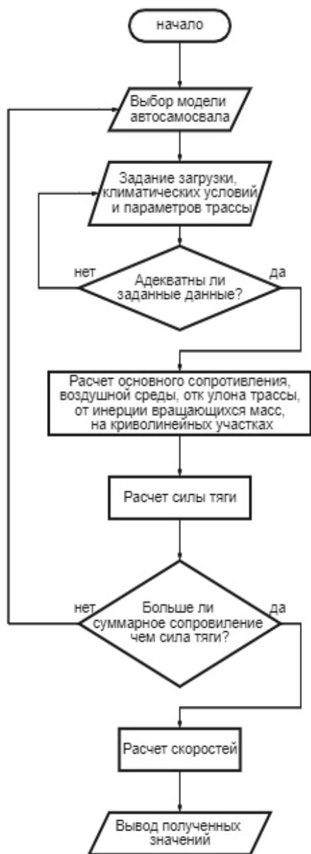
Рис. 2. Принципиальная блок-схема расчета скорости движения автосамосвала в зависимости от условий эксплуатации Fig. 2. Principle block diagram for calculating the speed of a dump truck depending on operating conditions
