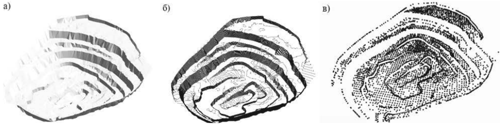
Рис. 8. Способы воссоздания топоповерхности: а – топоповерхность карьера в CIVIL, полученная с помощью алгоритмов триангуляции; б – топоповерхность Revit; в – данные маркшейдерской съемки в пространстве Dynamo (составлено авторами)
