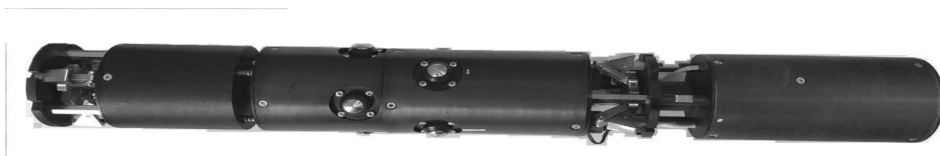
Рис. 6. Датчик деформаций ДД-3.4, оснащенный модулем беспроводной передачи данных Fig. 6. Deformation sensor DD-3.4, equipped with a wireless data transmission module
